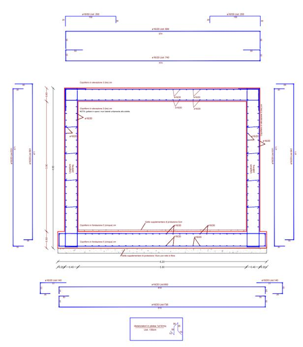
ARMATURA SEZIONE LONGITUDINALE
